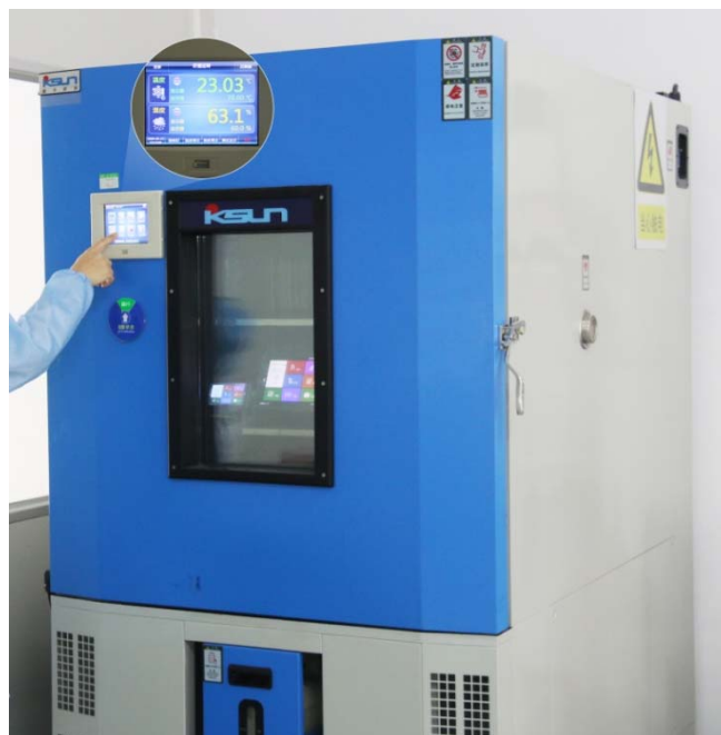
图 3-3 高低温老化测试图
